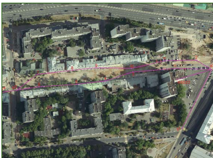
Рис. 4 Схема хода для определения координат эталонных точек
