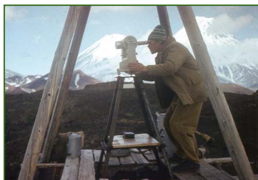
Наблюдения на пункте триангуляции 1 класса на геодинамическом полигоне. Камчатка, 1978 г. Фото А.В. Собщицова
