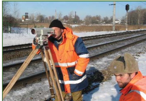
Создание специальной реперной системы высокоскоростной железнодорожной магистрали Москва — Санкт-Петербург, 2005–2006 гг. Фото А.Н. Осанкина
